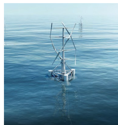
Eolienne flottante à axe vertical VERTIWIND
