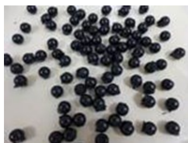
Granulés de bitume issus du projet GLOBE
