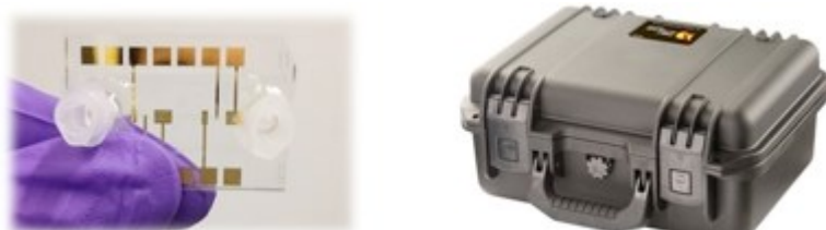
A gauche : puce microfluidique intégrant des microcapteurs électrochimiques. A droite : premier produit portable intégrant une cartouche de consommable pour l'Arsenic. Ce système permet de réaliser plus de 500 analyses.
