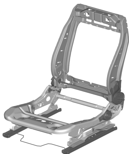
Structure de siège
