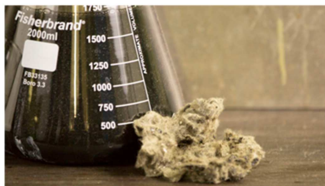
Pelote de fibres issues du traitement de membranes bitumineuses
