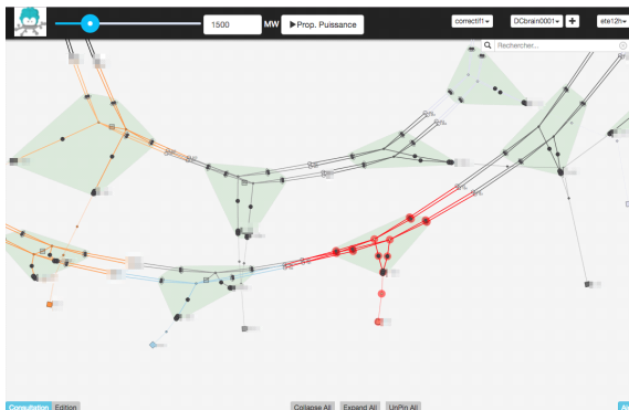
Visualisation d'un réseau et identification des capteurs présentant une dérive
