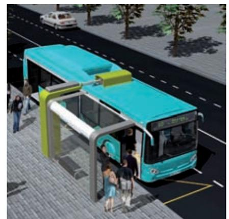
■ **Le SYSTEM'WATT** consiste à équiper **une chaîne de traction électrique sur un bus urbain standard** de 12 m et de PTAC 19 T. Ce bus est doté d'un pack de batteries de traction de capacité réduite, pour réaliser les trajets d'approche en ligne depuis son dépôt. En complément, il emporte des supercapacités, qui vont se recharger à chaque arrêt. Cette charge peut être réalisée en un temps très court (10 secondes), donc pendant le temps de montée et descente des passagers.
