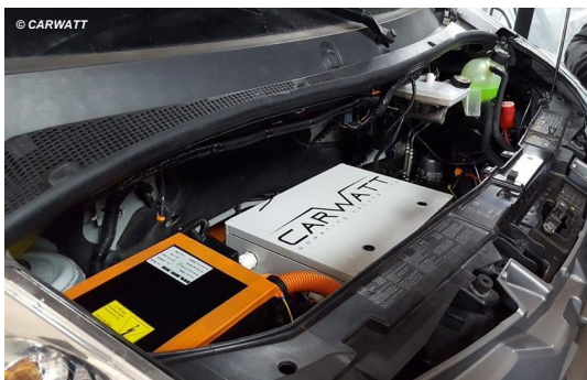
Premier prototype de véhicule utilitaire électrifié avec des batteries lithium-ion d'occasion
