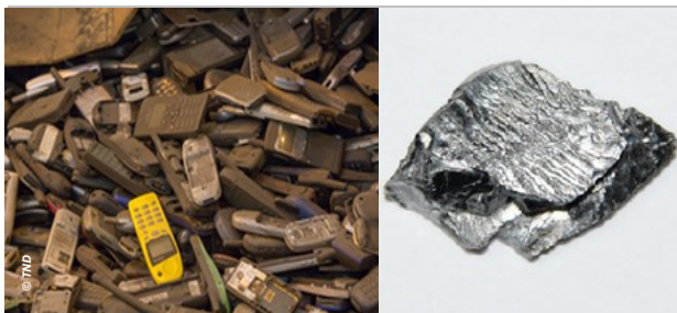
D3E à recycler (gauche) et échantillon de tantale (droite)
