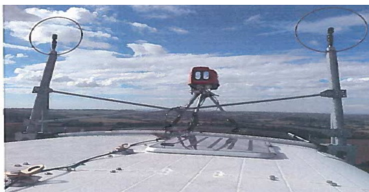
« Wind iris », installé fin 2015 sur le toit d'une nacelle éolienne
