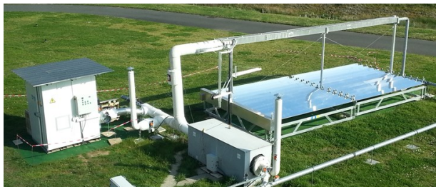
Prototype à l'échelle 1/10 de la centrale solaire
