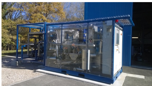
Exemple de machine à absorption, fabriquée par le CEA TECH
