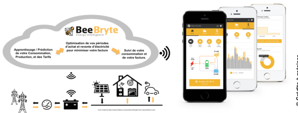
Figure : Principe de fonctionnement de la plateforme BeeBryte
