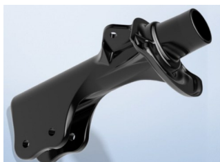
Corps extérieur d'amortisseur avant en composite
