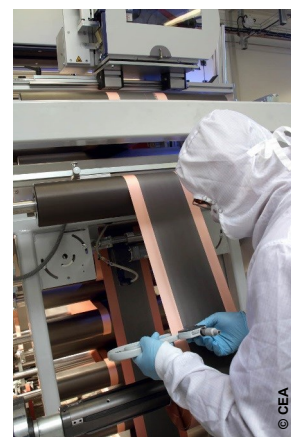
Ligne d'enduction pilote CEA
