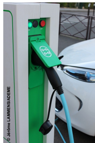
Recharge d'un véhicule électrique
