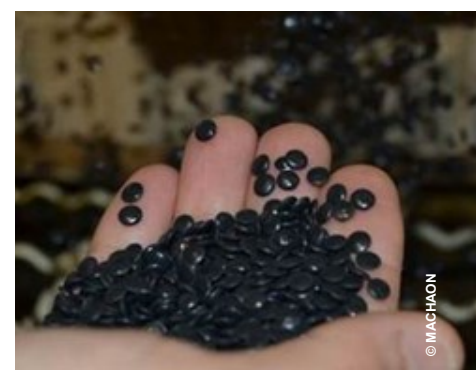
Recyclage des sacs plastiques en granulés de polyéthylène
