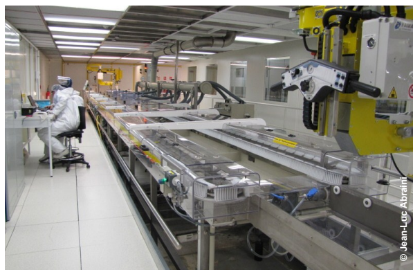
Equipement innovant d'électrodépôt à échelle 1 (60x120cm 2 )
